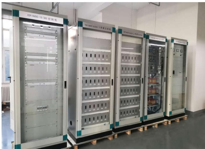
从左至右依次为：控制柜、下桥臂子模块柜、上桥臂子模块柜、电抗器柜和开关柜
